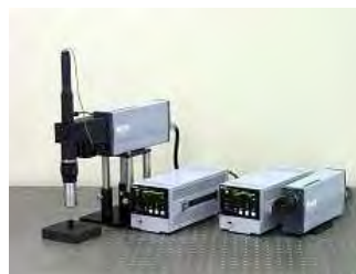
レーザードップラー振動センサー
