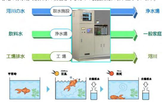
・『EQウォーター』は、『ユニレリーフ』と同じ魚のエネルギー測定原理を使う24 時間監視装置ですが、一般企業向けのため機器サイズがコンパクトになっています。 生産工場の排水処理対策及び地下水・工業用水の取水対策を用途としています。
